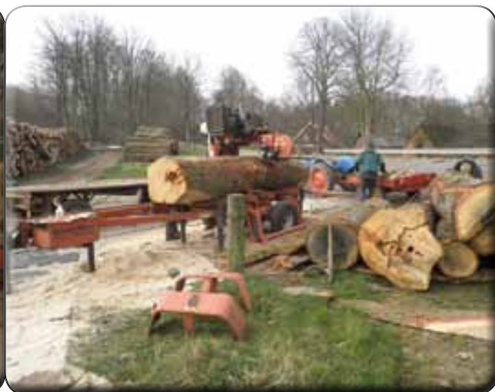
Egestammerne skæres op til bjælker og brædder
