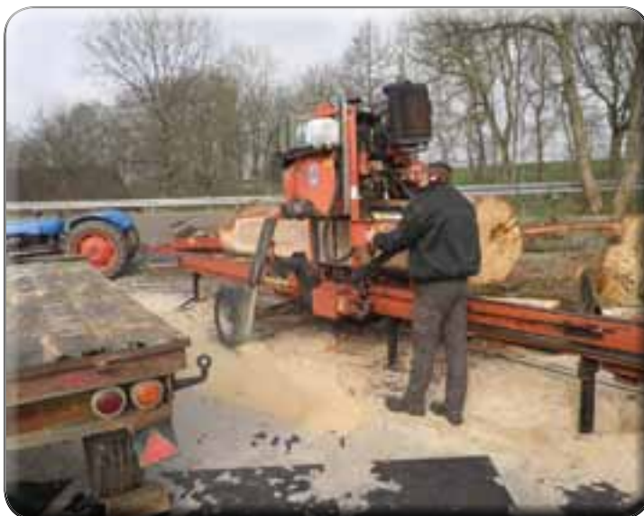
Egestammerne skæres op til bjælker og brædder
